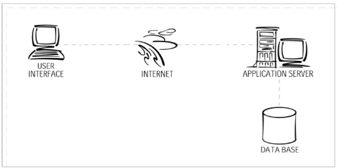
Figura 2: comunicazione in configurazione client/server con Anaconda Internet Application Server
